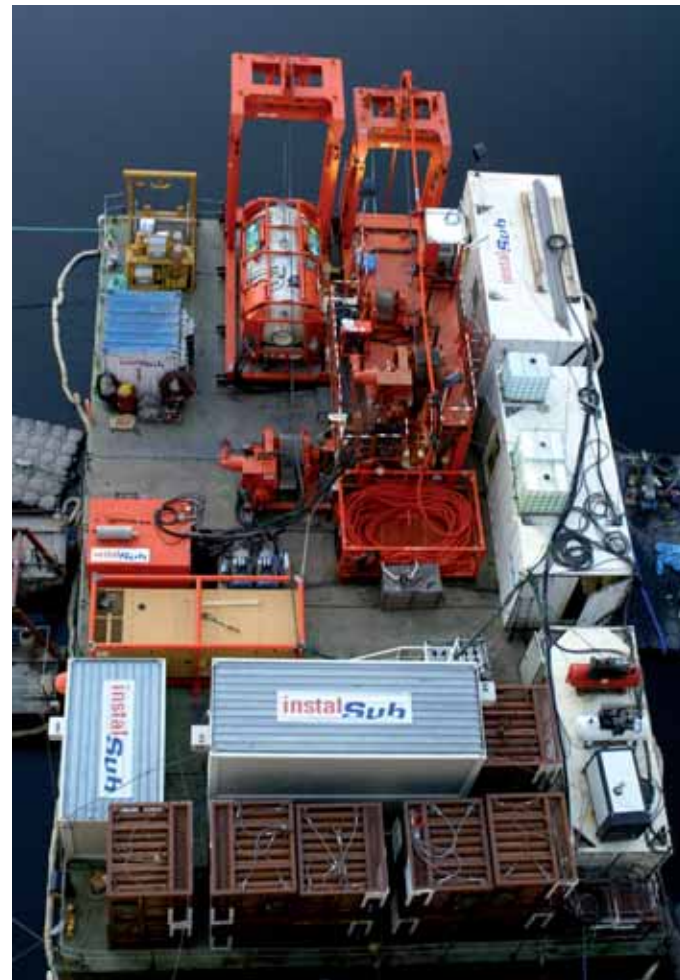
Se trata de un complejo de saturación transportable con capacidad para nueve personas.
